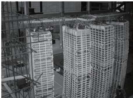
大型建筑物振动试验变形监测
